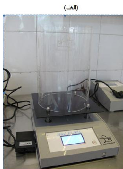
شکل ۴. الف - دستگاه آزمون صفحه داغ جهت ارزیابی اختلالات حس و پاسخ به درد حیوانات قبل و ۲۴ ساعت پس از وقوع ایسکمی. ب - دستگاه روتارود جهت ارزیابی حس تعادل و وضعیت حرکت حیوانات قبل و ۲۴ ساعت پس از وقوع ایسکمی مغزی.
