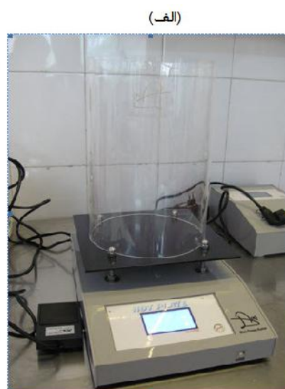
شکل ۴. الف - دستگاه آزمون حس صفحه داغ جهت ارزیابی اختلالات حس و پاسخ به درد حیوانات قبل و ۲۴ ساعت پس از وقوع ایسکمی. ب - دستگاه روتارود جهت ارزیابی حس تعادل و وضعیت حرکت حیوانات قبل و ۲۴ ساعت پس از وقوع ایسکمی مغزی.
